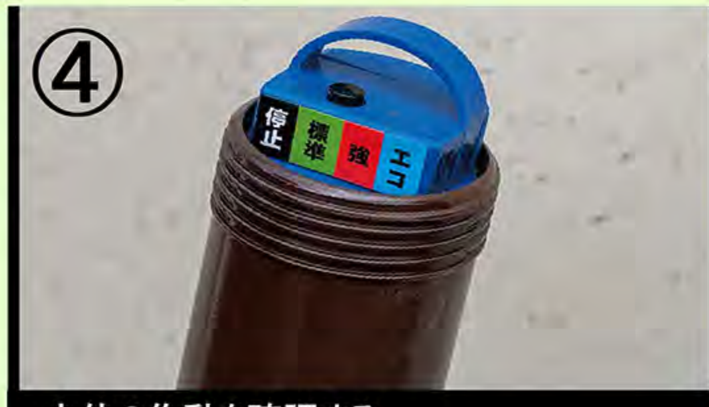
④ 本体の作動を確認する 電池をセットして垂直に持つ。 スイッチ SWI (緑) → SWII (赤) → SWIII (青) → OFF の順に作動と点灯を確認 再びSWI (緑) にして キャップを締めます。
