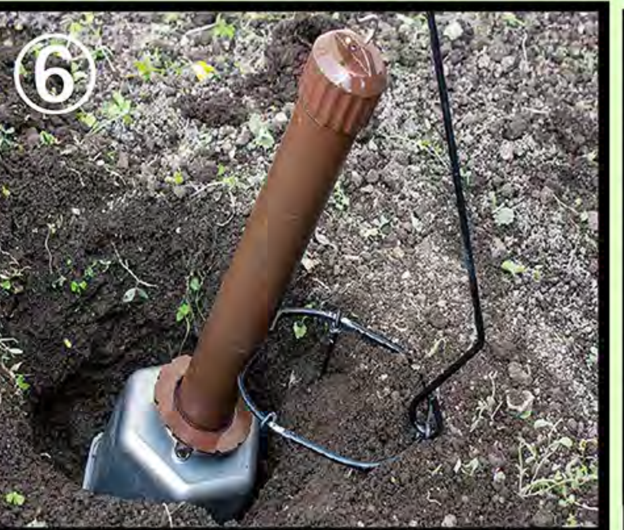
⑥ 地中にセット ・セットした本器を掘った穴に入れる。 支柱の台座を地中に水平にセットする。
